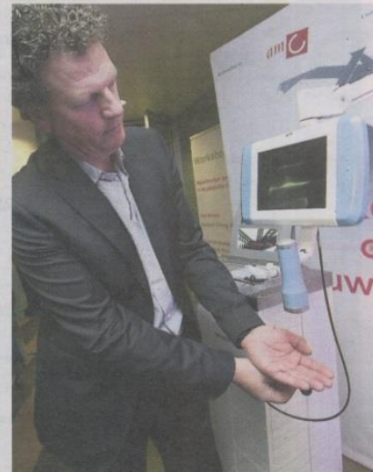
Ruud Verdaasdonk bedacht een infrarood navigatiesysteem, waarmee de weg van bloedvaten zichtbaar wordt. „Vooral kinderen of mensen met een donkere huid zijn zo gemakkelijker aan te prikken.“ FOTO'S ANKO STOFFELS
